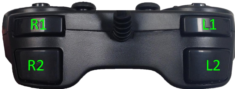
Abbildung 1 Programmier- und Steuertasten: R2, L2, R1, L1
